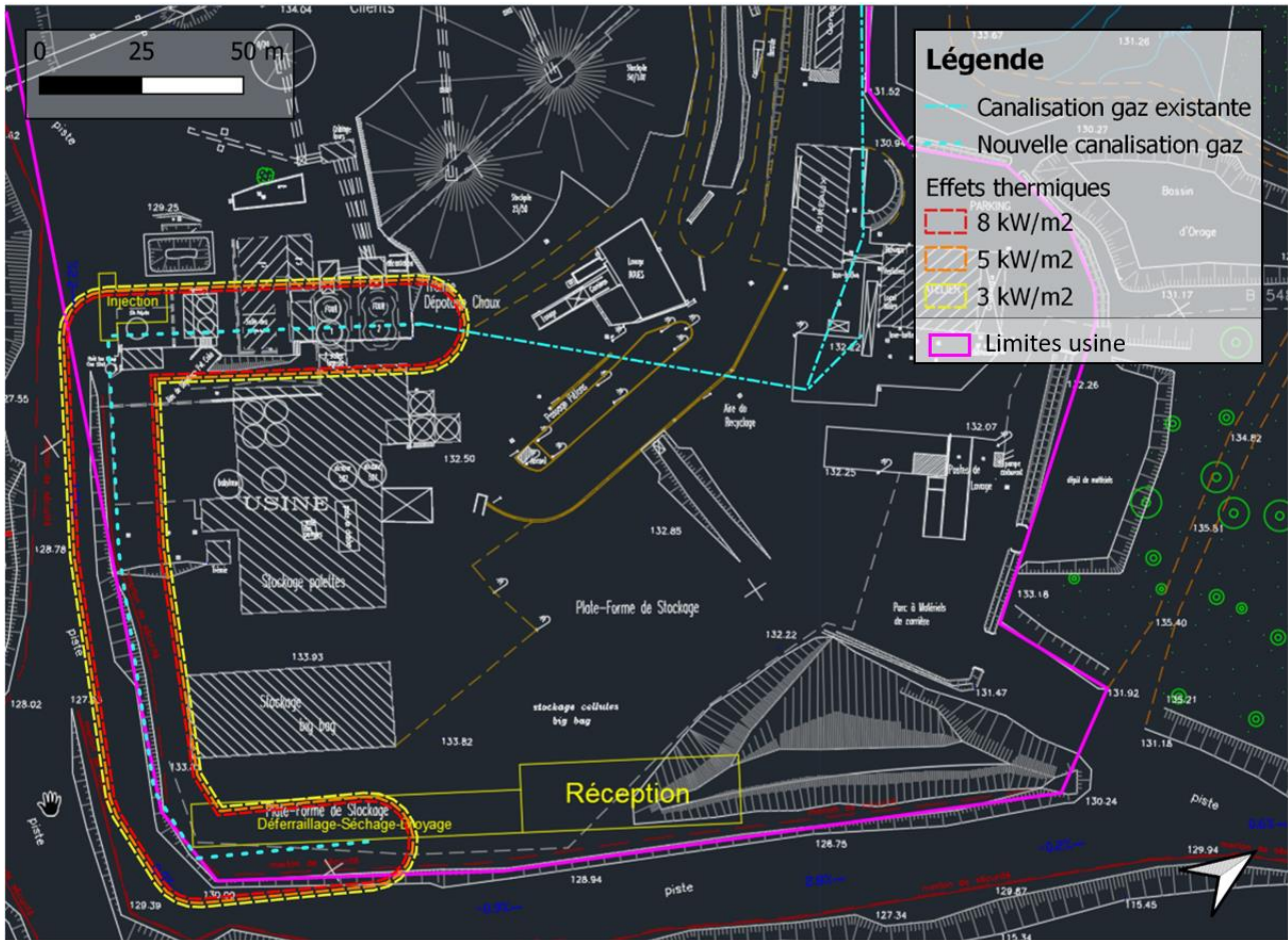
Figure 13 : Résultats des effets thermiques d'un jet enflammé – condition majorante F3 (PhD 26b-1)
