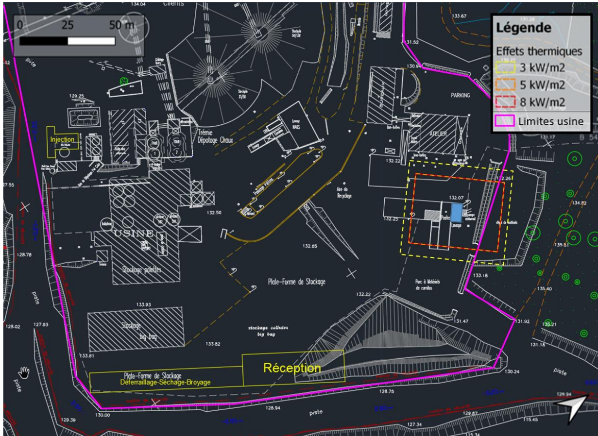
Figure 5 : Cartographie des effets thermiques en cas d'incendie d'une nappe de carburant au niveau de l'aire de dépotage
